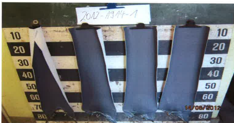
Aussehen der Probe A nach dem Brandschachtversuch
