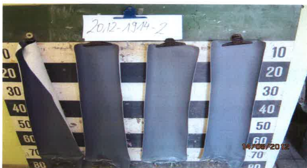
Aussehen der Probe B nach dem Brandschachtversuch
